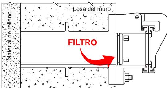
Instalación de Trumbull con el filtro en la válvula de alivio de presión
