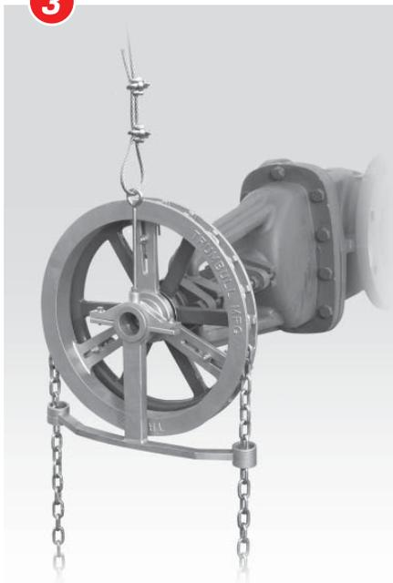
Faites une boucle en passant le câble dans le boulon à œil et en laissant environ 15 cm d'excès.
