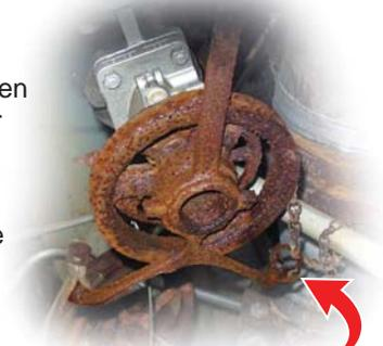
**KORRODIERTES GUSSEISEN-KETTENRAD** zeigt die Vorteile von Edelstahl
