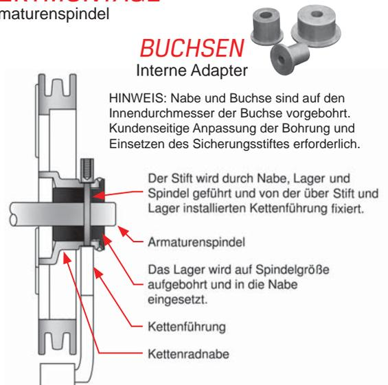
Adapter sind mit der runden Standardbohrung dargestellt. Andere Bohrungsdurchmesser, Formen, Anströmungen oder Passnuten auf Anfrage möglich.
