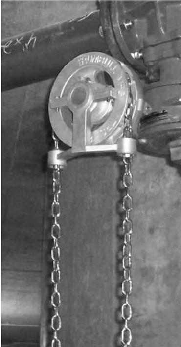
A **POLIAS DE CORRENTE DE AÇO INOX DA TRUMBULL** permitem a operação de válvulas elevadas com um ligeiro puxão na corrente. A concepção universal da polia de corrente permite que seja instalada em um volante ou anexada por pino diretamente à haste da válvula.
