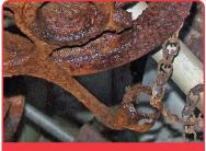
CORRODED CI CHAINWHEEL SHOWS ADVANTAGE OF STAINLESS STEEL.
